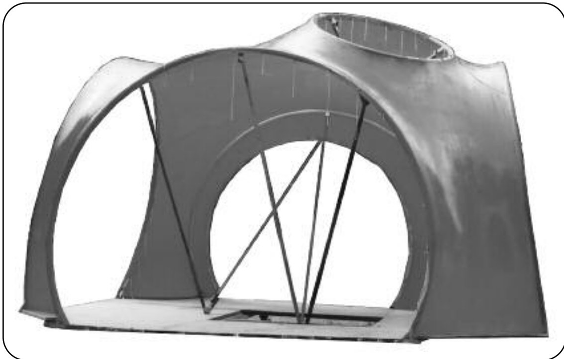
Essai de moule en textile étirable rigidifié, sous la conduite d'Antti Lovag.
